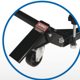
Pédales à came pour soulever avec roulettes pivotantes et pieds ajustables pour mise à niveau
